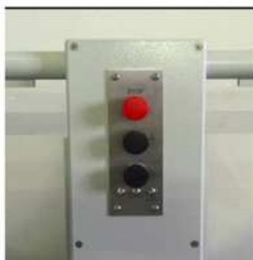
Contrôle sur la plateforme avec bouton d'arrêt ainsi que Led pour indication de surcharge et tension batterie
